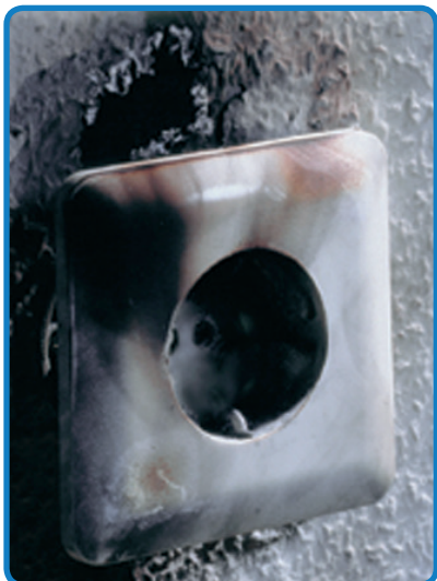
Spalone gniazdo elektryczne, Pożar domu Źródło: DEHN Polska sp. z o.o.
